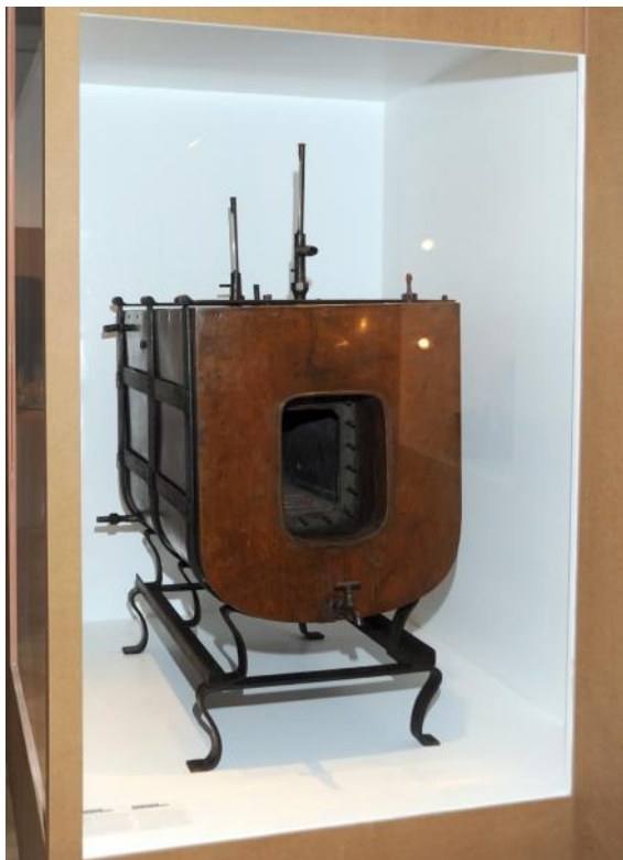
Εικόνα 4: Θερμιδομετρητής ζώων του Rubner's τον οποίο παρουσίασε κατά τη διάρκεια της έκθεσης "Energie = Arbeit" στο Βερολίνο το 2010; η φωτογραφία τραβήχτηκε από τον Elke Jung-Wolff; αναπαράχθηκε από τον Stiftung Brandenburger Tor, Berlin (Πνευματικά δικαιώματα Stiftung Brandenburger Tor)
